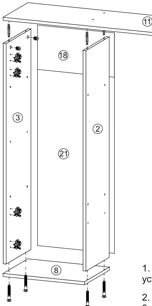
Монтаж эксцентриковой стяжки
