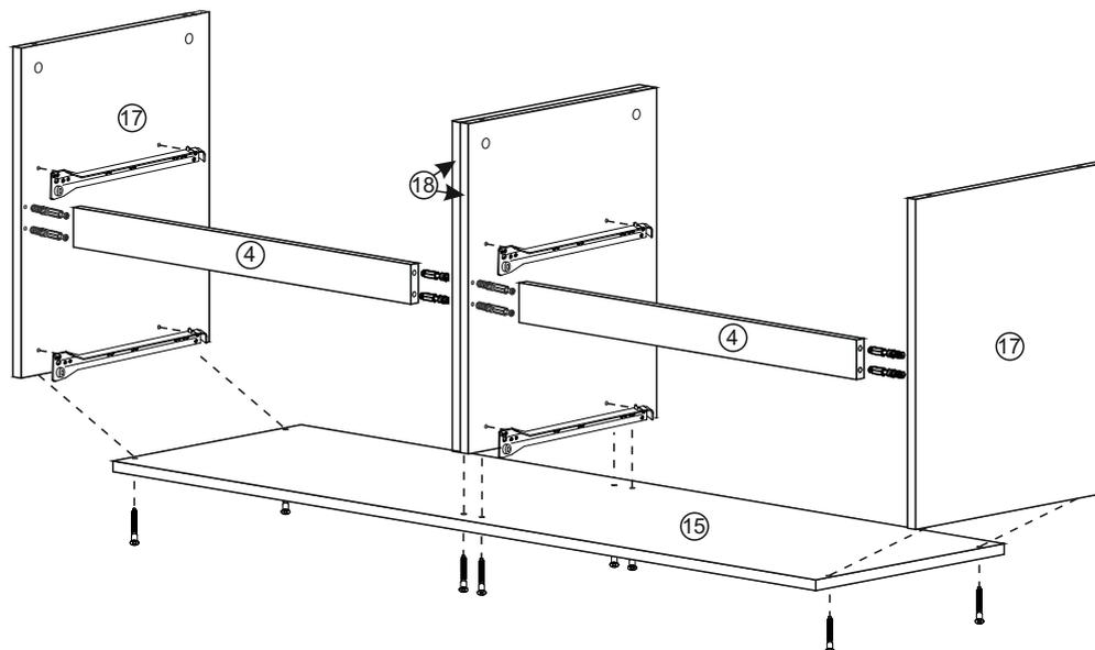
2. На боковины 17 и 18 установить эксцентрики и направляющие ящиков 350 мм еврошурупами 6,3\*10,5 мм, затем соединить боковины между собой планками 4 при помощи эксцентриковых стяжек.
