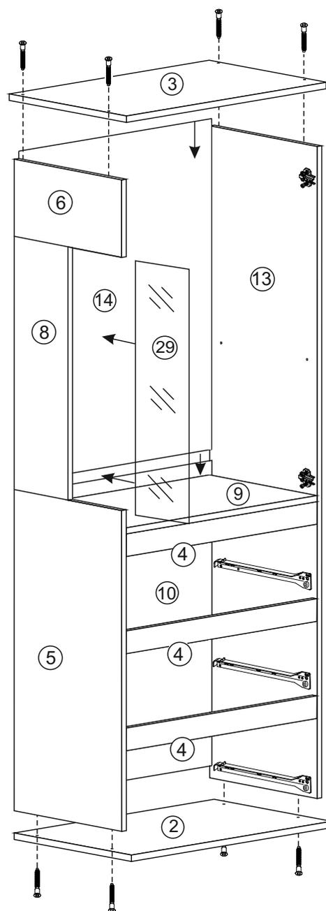
8. На боковины установить П-образные полкодержатели для стеклянной полки 27. Затем поставить полки.
