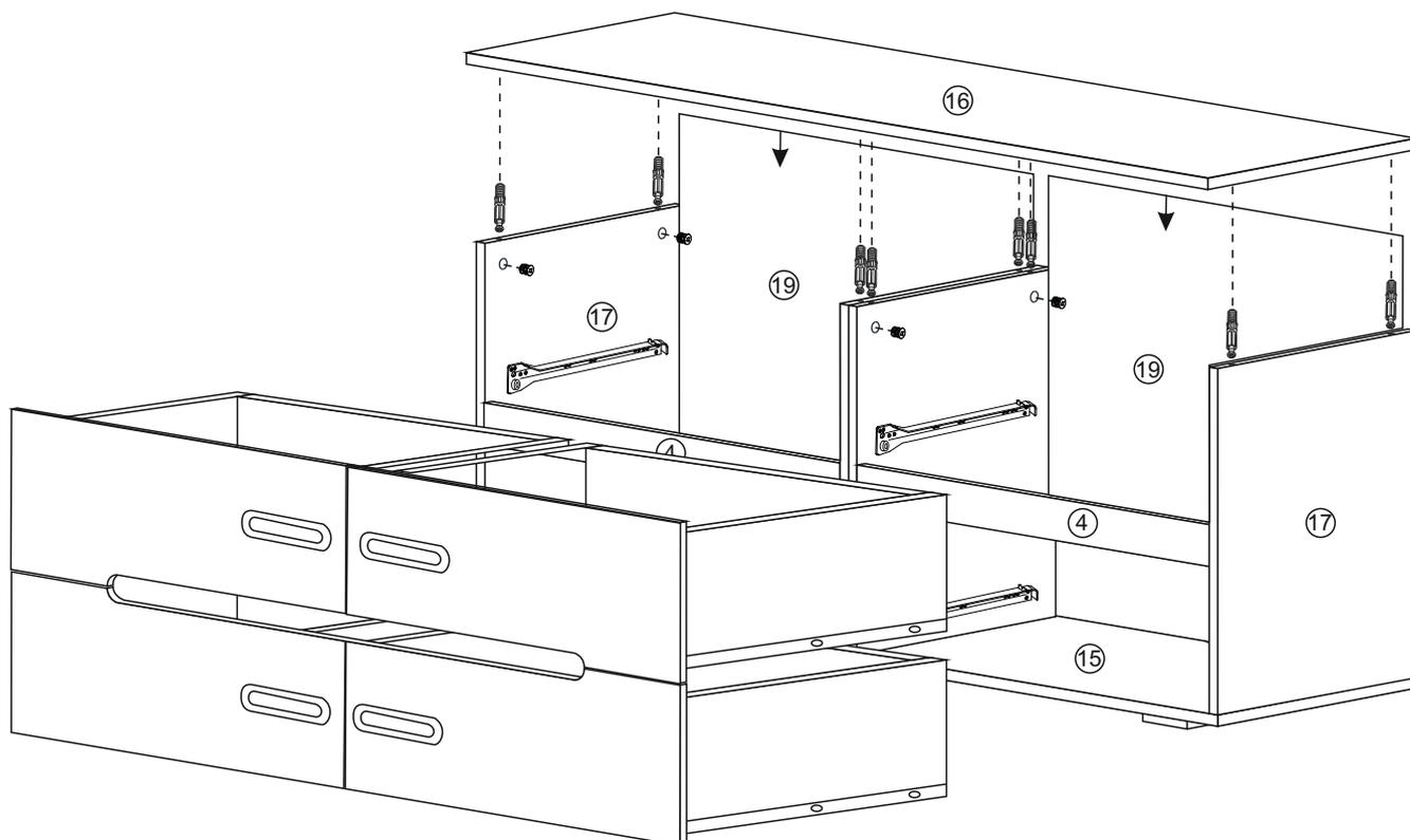
5. Прежде чем закрепить задние стенки 19 нужно выровнять диагональ, затем установить стабилизаторы Rv8. Опоры прикрепить к нижней крышке 15 используя шурупы 4\*13 мм.
