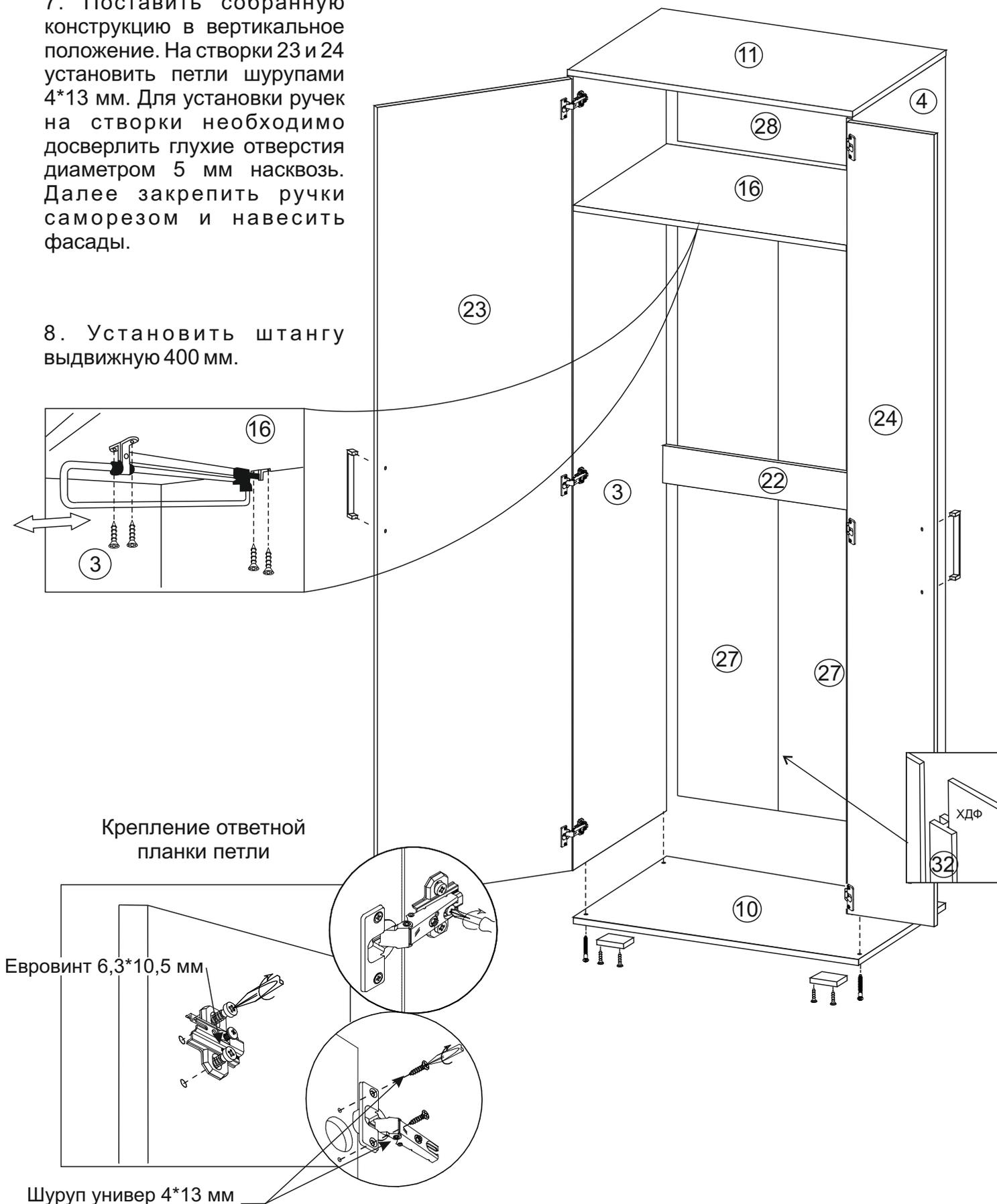
1. Сборка производится горизонтально, тыльной стороной вниз. Предварительно на боковинах 1 и 2 установить ответные планки петель евровинтами 6,3\*10,5 мм.
