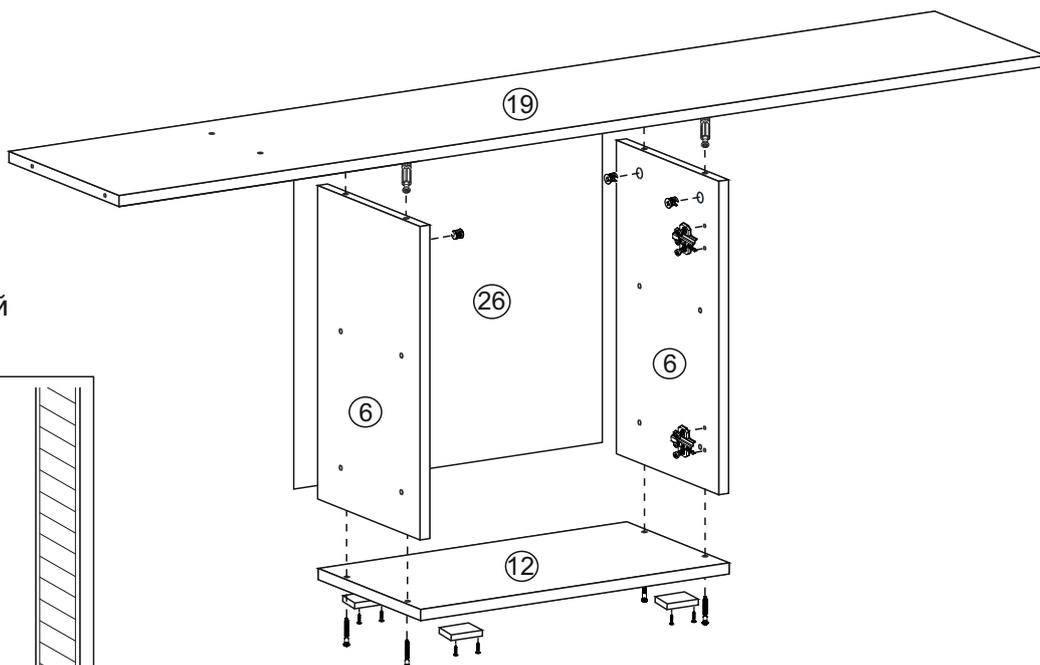
Монтаж эксцентриковой стяжки
