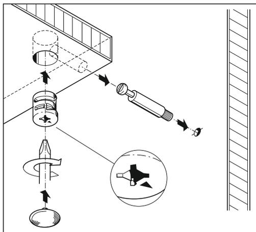
7. Собранные конструкции с помощью еврошурупов 7\*50 мм прикрепить к боковинам 1 и 4.
