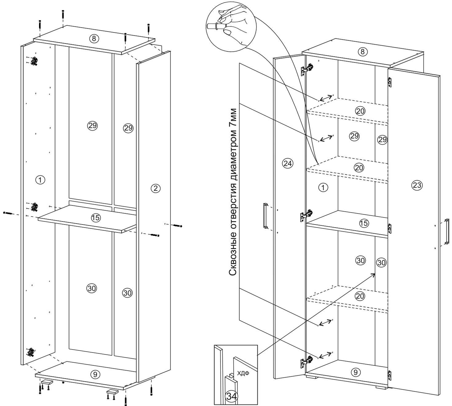
4. Для закрепления задней стенки 29 и 30 необходимо перевернуть модуль лицевой стороной вниз. После этого измерить и уравнять диагональ, приложить детали и выровнять углы. Задние стенки под номерами 29 и 30 закрепить соединительным брусом 33 и 34 соответственно. После выверки закрепить ХДФ гвоздями, используя шайбу пластмассовую.
