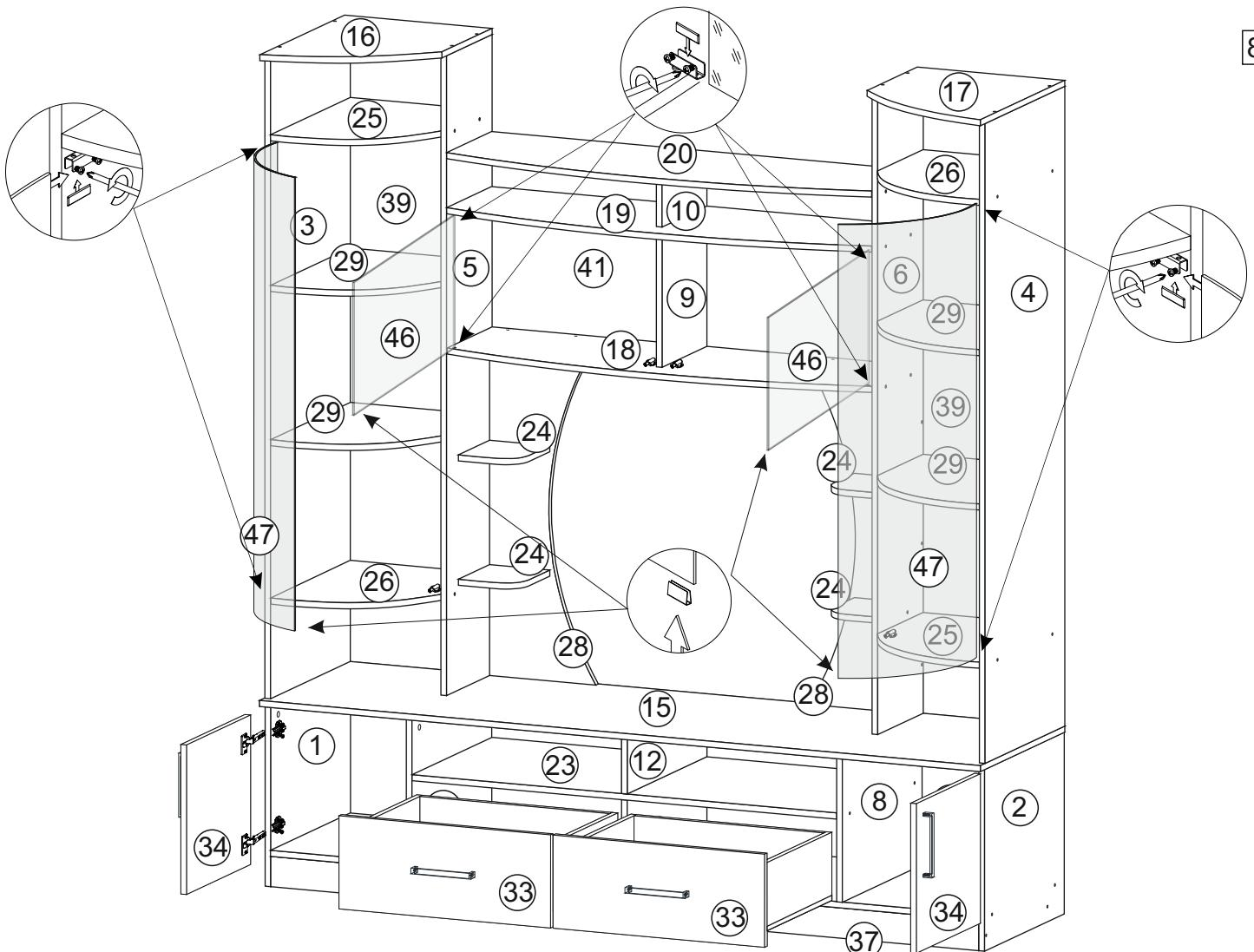
12. Навесить створки 34, предварительно закрепив на нем петли шурупами 4\*13 мм. Для установки ручек на створки необходимо досверлить глухие отверстия диаметром 5 мм насеквоздь. Далее закрепить ручки саморезами.
