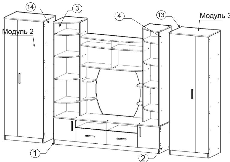
Скрепить между собой Модули 1, 2 и 3 межсекционными стяжками. Для этого просверлить в боковине 1 и 2, 3 и 4, а также на одной из двух боковин 13 и 14 (в зависимости от расположения шкафов) на расстоянии около 10-15 см от каждого угла стенок два сквозных отверстия диаметром 5 мм на одном уровне. Гайки стяжек входят в отверстие, и крепеж свинчивается.
