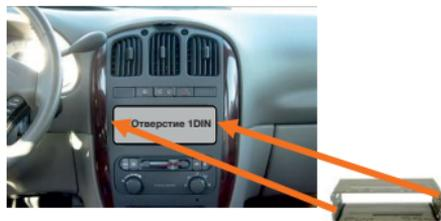
1. Установите монтажный кожух в отверстие стандарта 1DIN, предусмотренное заводом изготовителем. В случае если штатное место имеет размер 2DIN, используйте переходные рамки и адаптеры торговой марки **AURA**
