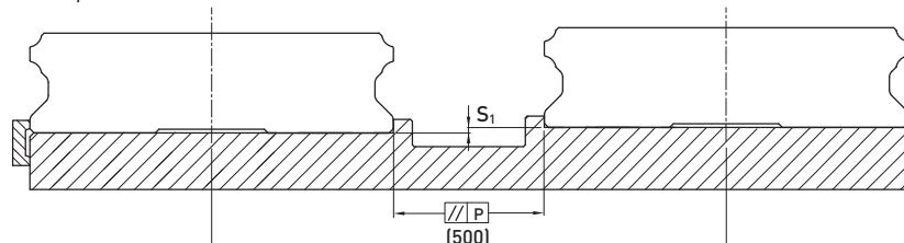
Табл. 2-5-14 Max. допуск параллельности (P)
