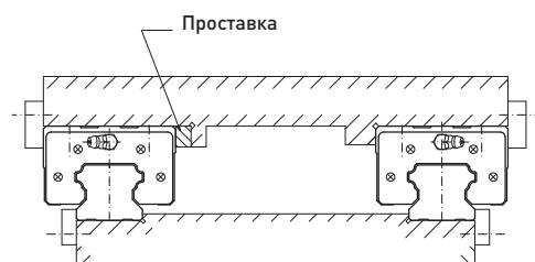
HGW тип каретки с крепежными отверстиями в различных направлениях.
