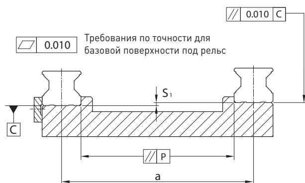
Табл. 2-7-22 Max. допуск параллельности (P)
