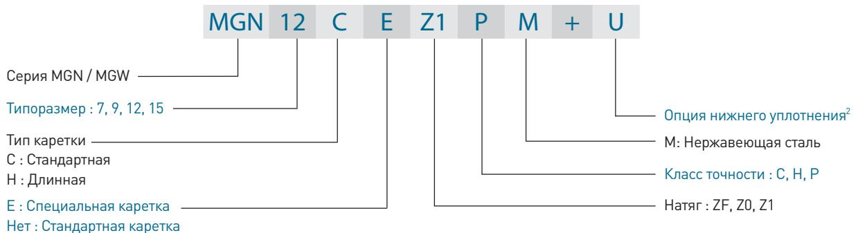
○ Маркировка направляющей серии MG
