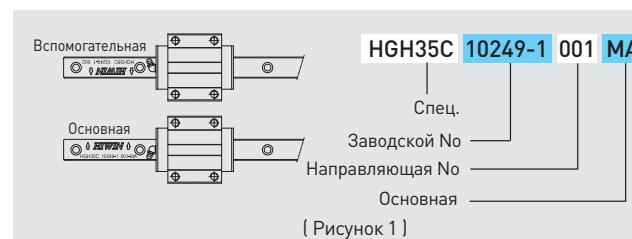
3. Определение базовой поверхности: базовая поверхность (B) направляющей это сторона, указанная стрелкой, которая промаркирована на верхней поверхности рельса. Базовая поверхность каретки - гладкая поверхность каретки, указанная как D на рисунке 2.
