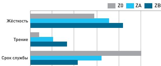
Рисунок отображает взаимосвязь между жёсткостью, трением и номинальным сроком службы. Преднатяг не более ZA рекомендован для небольших типоразмеров для предотвращения перегрузки, влияющей на срок службы направляющей.
