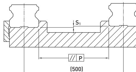
Табл. 2-2-16 Max. допуск параллельности (P)
