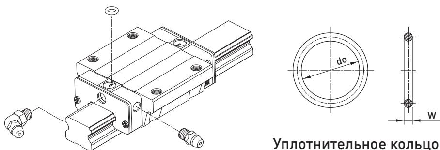
Табл. 2-2-9 Размер уплотнительного кольца и максимально допустимая глубина установки
