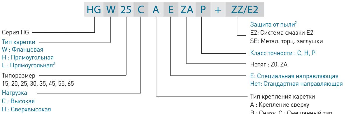
○ Маркировка направляющей серии HG
