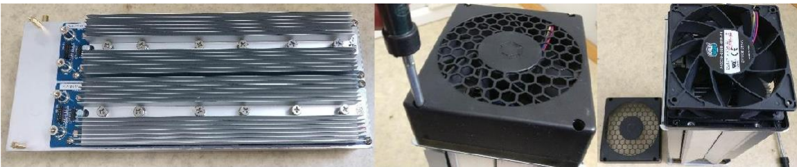
Изображение 22. Набор фото 7: майнер AvalonMiner 841 в разобранном виде.
