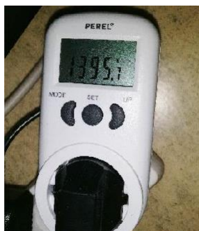
Изображение 61. Измерение потребляемой мощности при значении смещения напряжения +1.
