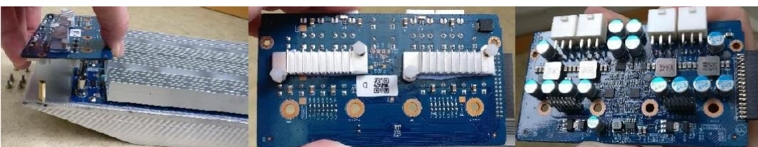
Изображение 19. Набор фото 4: майнер AvalonMiner 841 в разобранном виде.
