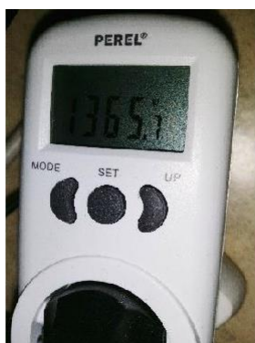
Изображение 59. Измерение потребляемой мощности при значении смещения напряжения -1.
