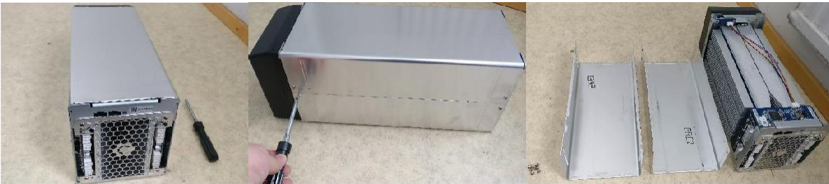
Изображение 16. Набор фото 1: майнер AvalonMiner 841 в разобранном виде.
