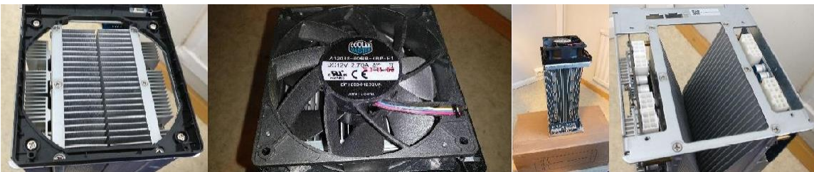
Изображение 23. Набор фото 8: майнер AvalonMiner 841 в разобранном виде.
