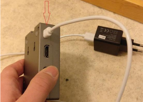
Изображение 35. Подключение питания = 5 В к контроллеру.
