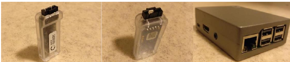
Изображение 10. Конвертер AUC3 и контроллер AvalonMiner.
