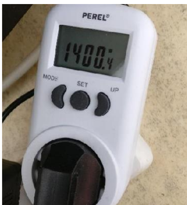
Изображение 53. Измерение мощности, второй контрольный запуск.
