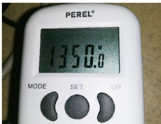
Изображение 51. Измерение мощности, первый контрольный запуск.
