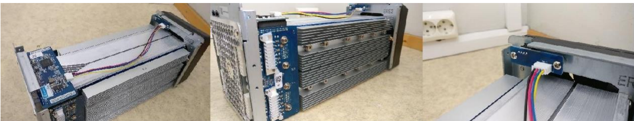
Изображение 18. Набор фото 3: майнер AvalonMiner 841 в разобранном виде.
