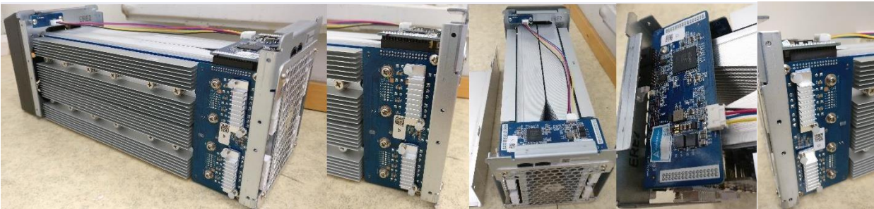
Изображение 17. Набор фото 2: майнер AvalonMiner 841 в разобранном виде.
