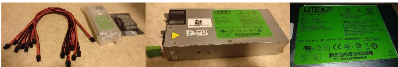
Изображение 13. Серверный блок питания Lite-On PS-2142-2L 1400W.
