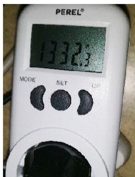
Изображение 58. Измерение потребляемой мощности при значении смещения напряжения -2.
