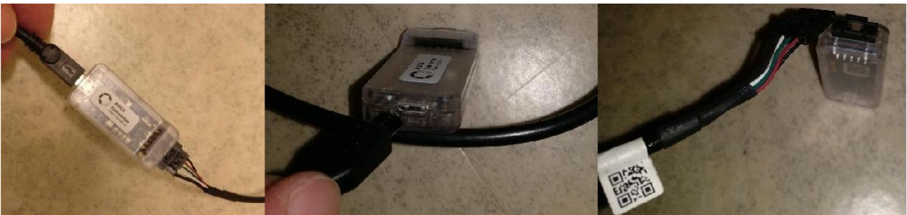
Изображение 37. Подключение кабелей к конвертеру AUC3.
