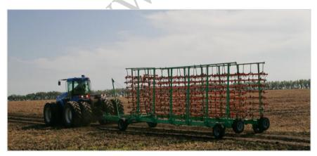
Уникальность данной сельхозмашины в том, что полотна работают в трёх плоскостях и состоят из толстостенных труб, соединенных между собой звеньями круглозвенной цепи, на которые установлены зубья ромбического профиля.
