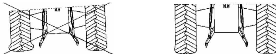
Нижние тяговые штанги навесной системы трактора перед тем как навесить машину должны быть переставлены в нижнее положение на той же самой высоте (минимальное расстояние шарниров от земли 200 мм). Тяговые штанги, установленные на одинаковой высоте от земли облегчат навешивание сеялки на трактор.
