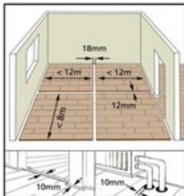
В помещениях, продольный размер которых составляет более 12 м длины панели и /или поперечный размер – более 8 м ширины панелей, дополнительно должен устанавливаться расширительный профиль. Это также касается дверных проемов, проходов помещений, выступов стен и помещений с большим количеством углов. Мы рекомендуем удалять в области расширительных профилей гребень панелей, чтобы гарантировать достаточное пространство для движения.
