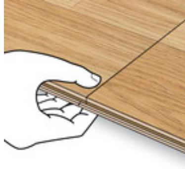
5. Последний ряд ламината в большинстве случаев требует обрезки по ширине. Обрежьте панели, соблюдая расстояние до стены.
