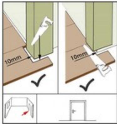
Деревянные дверные коробки необходимо укорачивать. Приложите панель к дверной коробке декоративной стороной вниз. Затем обрежьте дверную коробку вдоль панели подходящей пилой. После этого просуньте ламинат под дверную коробку декоративной стороной вверх. В случае с металлическими дверными коробками обрезке подлежит панель ламинаата.
