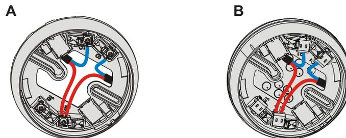
Основание извещателя с винтовыми клеммами (A) и зажимными клеммами (B)
