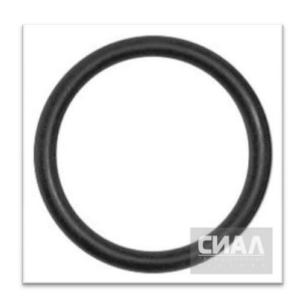
Кольца уплотнительные круглого сечения из резины (NBR) обладают маслобензостойкостью, функционируют в диапазоне температур от -20 °C до +100 °C. Кольца из резины (NBR) обладают высокой твердостью и для резиновых эластомеров относительно высокой устойчивостью к истиранию. При высоких температурах ускоряется процесс старения, однако при перекрытии доступа воздуха (например, при работе в масле) к кольцу старение значительно замедляется.
