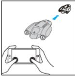
1. Presione y mantenga presionado el botón on/off para encender el PowerDolphin. Las luces azules de la barra lateral indican que está encendido.
