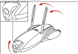
3. Despliegue las antenas y ajuste la parte manual de la cámara a una posición adecuada.
