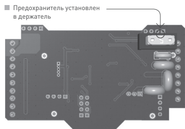
Рис. 2 – Нижняя часть верхней печатной платы
