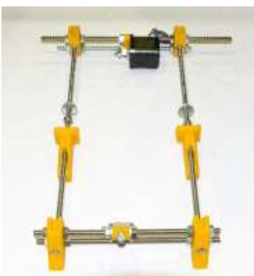
Для этого продеваем шпильки (28) продольных направляющих в отверстия ножек, закрепленных на поперечных направляющих. В результате чего мы должны получить прямоугольный каркас нашего принтера.
