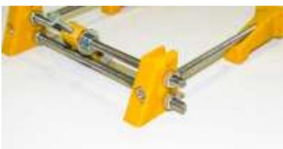
Гайками стянем наш каркас для придания жесткости конструкции.
