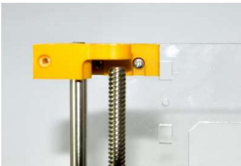
Закрепите крепежи к раме оси Z с помощью винтов.
