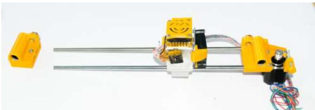
А следом продеваем экструдер через линейные подшипники. Таким образом, чтобы те подшипники, которые в паре оказались сверху.
