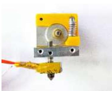
Для начала необходимо на двигатель с установленной шестерней (16) закрепить подкладку экструдера (33) винтом (17а) и в отверстие вставить пружину сжатия (22а). Далее приложить нагревательный узел экструдера (20) как показано на рисунке
