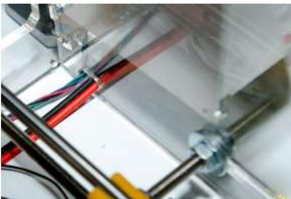
... и блока питания осуществляем через технологически отверстия в корпусе принтера.
