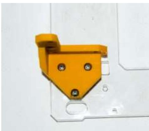
Закрепите держатель двигателя по оси Z (правый) (31) на раме оси Z (29).
