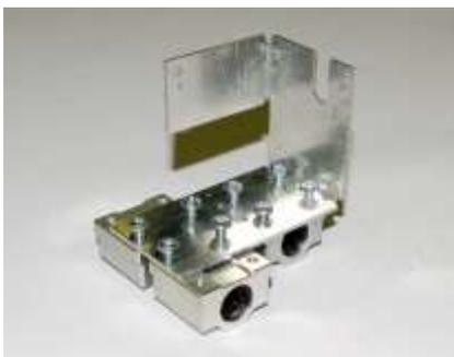
Закрепляем подшипники в таком порядке, как на рисунке. Те подшипники, что в паре не жестко закрепляем винтами (фиксировать нужно при установке на ось X)
