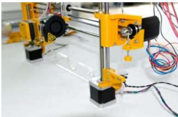
Закрепите Держатель концевого выключателя (34) на держателе двигателя (31).
