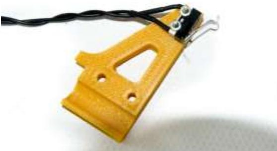
Прикрепите концевой выключатель с проводом (14) к держателю концевого выключателя по оси Z (34) с помощью винтов (15А).
