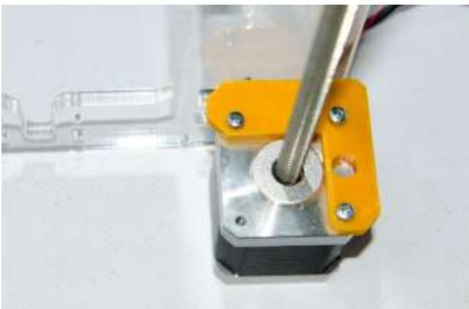
Закрепите шаговые двигатели (8) с помощью трех винтов (11) к держателю двигателя (31) слева и к держателю двигателя (45) справа.
