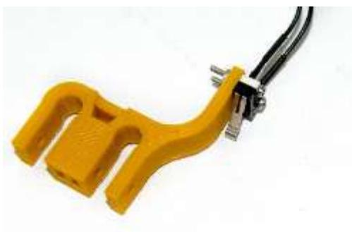
Вначале подсоединяем механический концевик.
