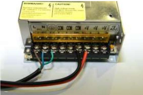
Открыв защитную крышку, подсоединяем провода внешнего питания («фаза», «ноль» и «земля») и питания платы (+V и «ноль») согласно схематичному изображению на блоке питания.
