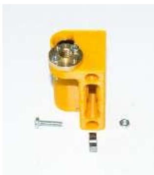
для установки нам потребуется подшипник оси X (19а), винт (10а) и гайка (6а)
