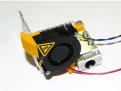
Устанавливаем турбину на крепление экструдера винтом (14а)
