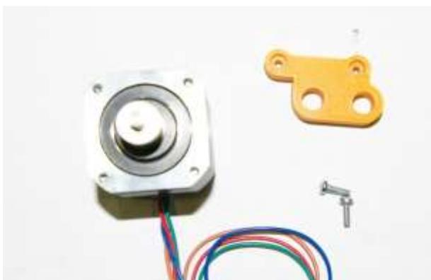
Для начала установим крепление двигателя (52) с помощью винтов (18А)
