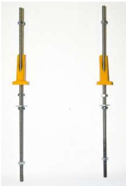
По центру винта (28) устанавливаем шайбу (1А), с обеих сторон завинчиваем гайки (4А), затем с одной стороны продеваем деталь (55) и по краям еще завинчиваем гайки (4А). Данную процедуру повторяем для второго винта (28). В результате должны получиться две направляющие как показано на рисунке.
