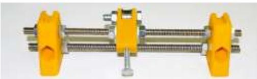
Натяжитель при этом устанавливаем на верхней шпильке. Отцентрировав его и притянув также двумя гайками (7) с шайбами (1А).
